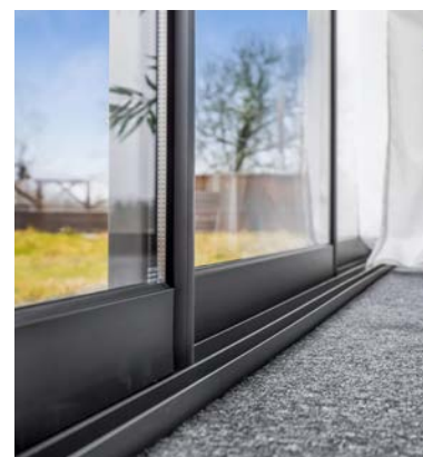
Sidoprofiler med rundad design. Profilerna hakar i varandra, vilket ger ökad stabilitet och täthet.
